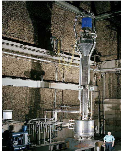
รูปที่ 2 เครื่องยนต์ความร้อนและเครื่องทำความเย็นแบบเทอร์โมอะคูสติก [14]
