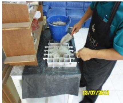
(ค) เทส่วนผสมลงในเบ้าหล่อสำหรับบล็อกคอนกรีตทรงลูกบาศก์ขนาด 5 x 5 x 5 ซม. ให้เต็มพอดี
